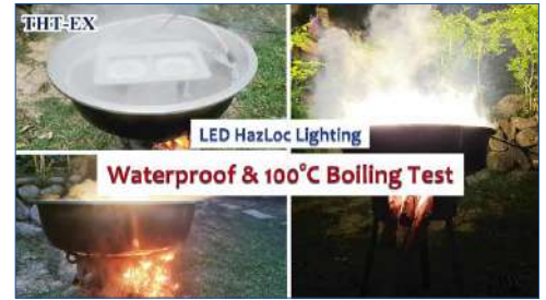
照明器具の防水及び 100°C沸騰水試験
