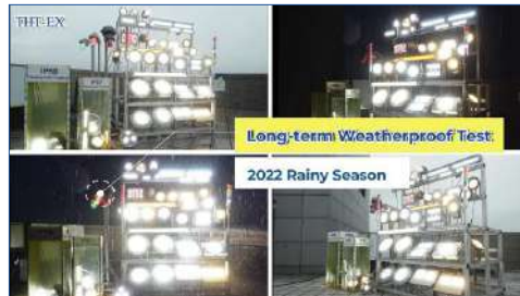
屋外長時間点灯 耐候性試験
